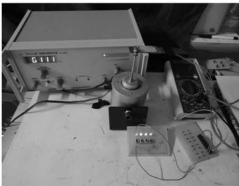
图 6 振动发电 LED 照明系统
